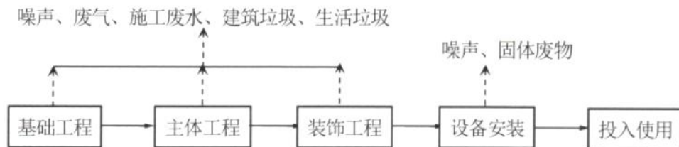
图 3 施工期工艺流程及产污节点图
